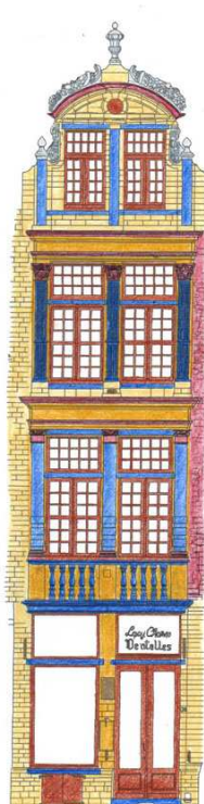
Extrait de l'état des lieux des façades de la Grand-Place. Plans des matériaux et des pathologies réalisés par maison, exemple maison n° 39 L'Ané.
